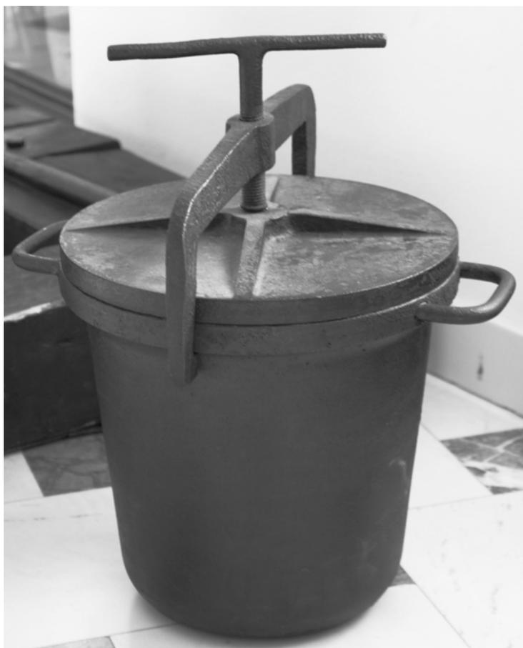
Abb. 32 Schüttelgefäß für die Herstellung von nassem Zinnober aus dem 19. Jahrhundert in Idria, Heimatmuseum Idria 2004
